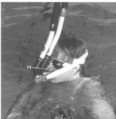
Abb. 3: Bild aus der Veröffentlichung von Toussaint et al., 1987. H=Nasenklammer, F=Schlauch mit Umgebungsluft zum Einatmen, E=Schlauch für Expirationsluft, J=Fixierungsgürtel am Kopf.
