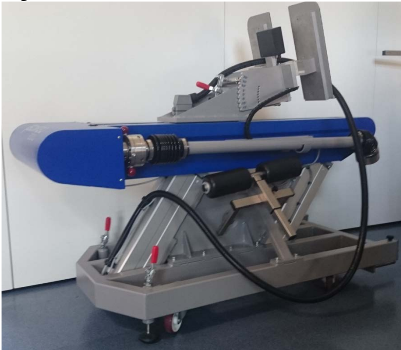
Abb. 3: Beinpressenmodul des Isomed 2000
