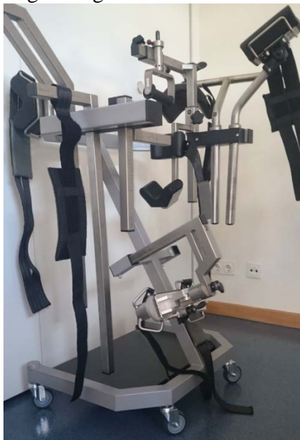
Abb. 1: Isomed 2000 Grundmodul. Aufbau für das Training des Kniegelenks im Sitzen. Die ein- und beidseitige Belastung der oberen und unteren Extremitäten ermöglichen (s. Abb. 2).
